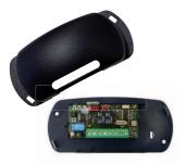
Récepteur Rolling Code 2 canaux avec connecteur à 10 voies (embrochable) ou avec bornier à 8 voies en box. Mémoire extractible de 1000 transmetteurs. Relais avec selection fonctionnement impulsif, pas à pas et temporisé.
