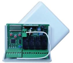
Récepteur rolling code 4 canaux. Mémoire amovible de 1000 émetteurs. Relais **16A 230 Vac** avec sélection de fonctionnement impulsif, étape par étape, temporisé ou retardé. Une entrée câblée unique pour chaque canal. 3 types d'apprentissage: automatique, avec LED et personnalisé. Récepteur avec gestion d'un émetteur à travers le display et gestion activation/désactivation d'un canal unique, d'un bouton ou d'un émetteur. Alimentation **12/24 Vdc/Vac**.
