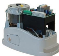
KALOS è un motoriduttore elettromeccanico irreversibile 230 Vac per cancelli scorrevoli fino a 1200 kg di peso. Centralina BIOS1 incorporata con ricevitore radio, rallentamenti, sicurezze e gestione di un trasmettitori da display.
