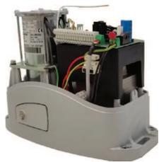
**KALOS 24V** est un motoréducteur électromécanique irréversible 24 Vdc pour portails coulissants jusqu'à 1100 kg. Centrale SCOR.AS incorporée avec récepteur radio, Ralentissements et dispositifs de sécurité.
