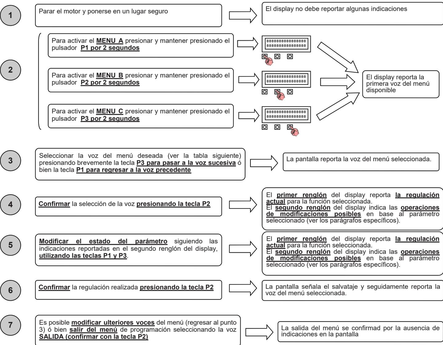
SALIDA AUTOMATICA DEL MENU: En caso de inactividad prolongada (15 segundos) el menú se desactiva automáticamente.
