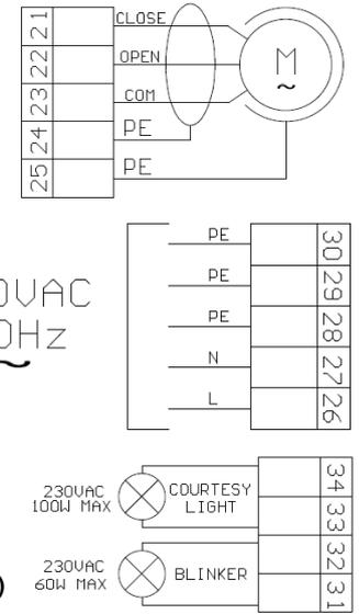
Per il collegamento del motore si consiglia l'utilizzo di cavo schermato 3 poli + terra da 1.5mm<sup>2</sup> (tipo FD781CY)
