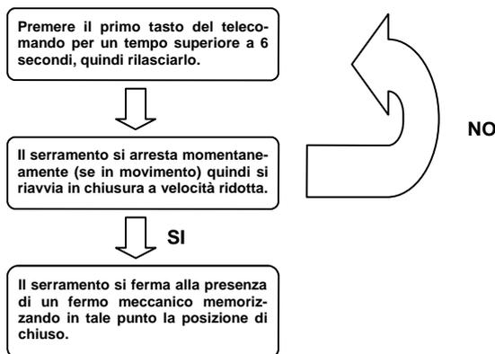
**ATTENZIONE:** durante l'operazione di resincronizzazione l'intervento della sicurezza antischiacciamento viene interpretato come identificazione della posizione di chiuso. Per evitarne l'intervento involontario la sensibilità della stessa risulta notevolmente ridotta rispetto alle condizioni di normale funzionamento.
