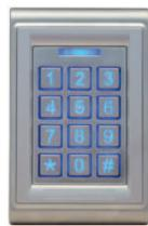
**AM1 PAD** Tastiera controllo accessi autonoma, retroilluminata, 1000 utenti, 2 relè di uscita, 12/24Vdc, tamper ottico.
