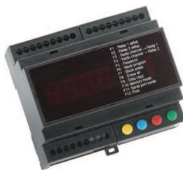
**M2E** Centralina controllo accessi, 2000 utenti, ricevitore radio Allmatic 433.92 Mhz, 2 ingressi per lettore di prossimità, 2 relè di uscita, gestione a display degli utenti, 12/24 Vac/dc.
