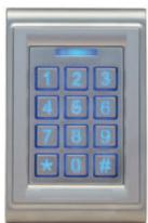
**AM1 PAD** Clavier contrôle accès autonome, 1000 utilisateurs, 2 relais de sortie, 12/24Vdc, tamper optique.
