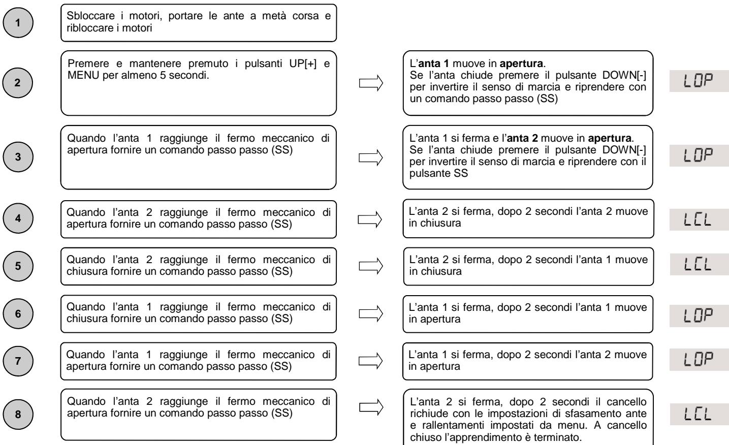
**Attenzione:** in caso di intervento di un dispositivo di sicurezza, la procedura viene arrestata e appare a display la scritta **L --**
