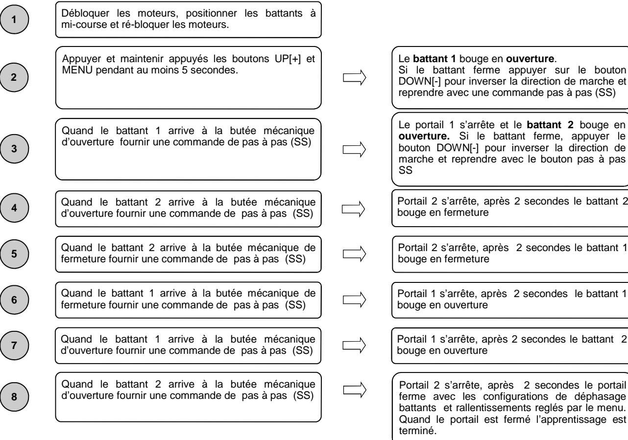
**Attention:** en cas d'intervention d'un dispositif de sécurité, la procédure sera arrêtée et l'écran affichera le message Appuyer sur la touche pas à pas pour redémarrer l'apprentissage à partir de l'étape 2.
