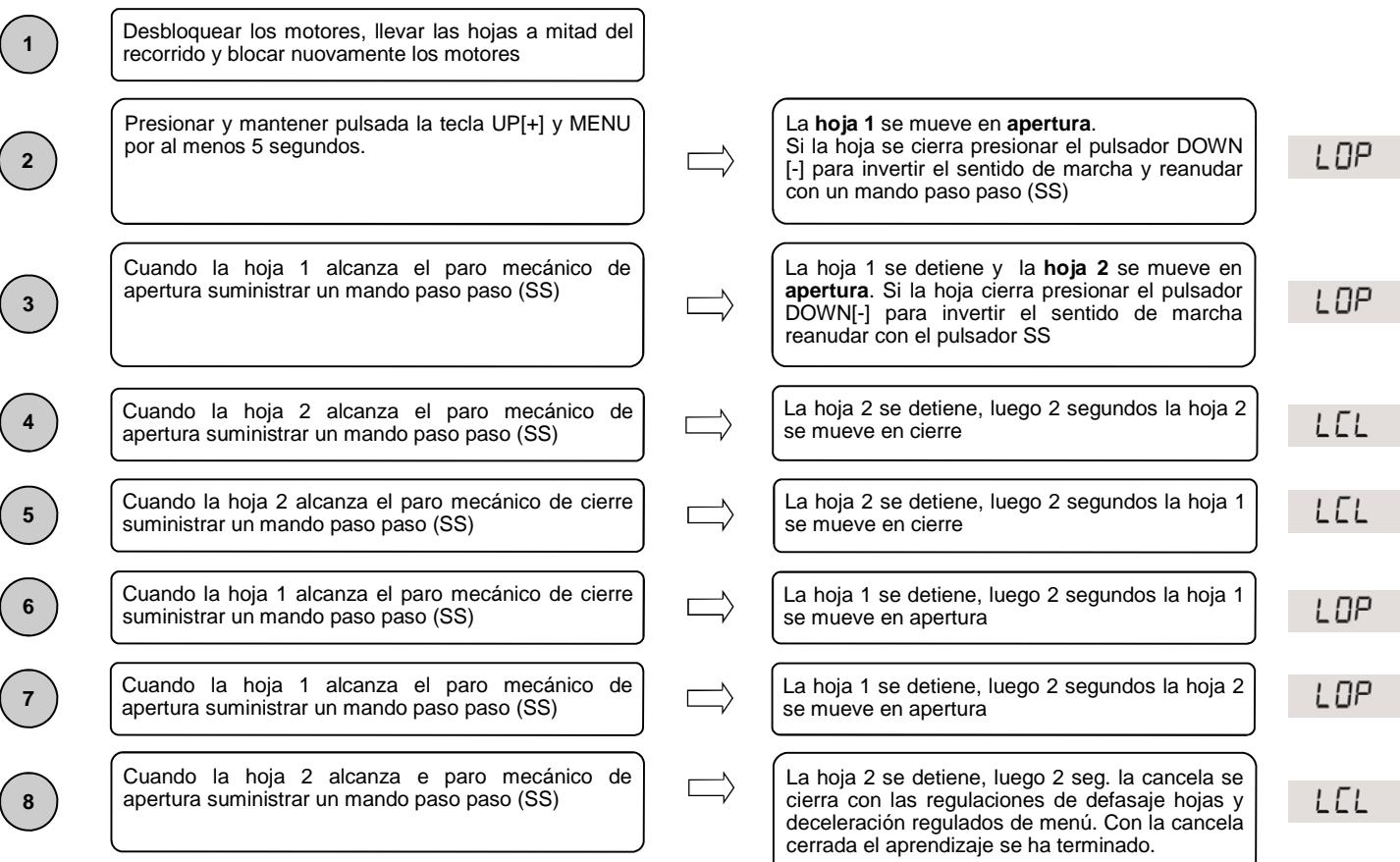
**Cuidado:** en el caso de intervención de un dispositivo de seguridad, el procedimiento se detiene y aparece en el display la palabra **L - -**
