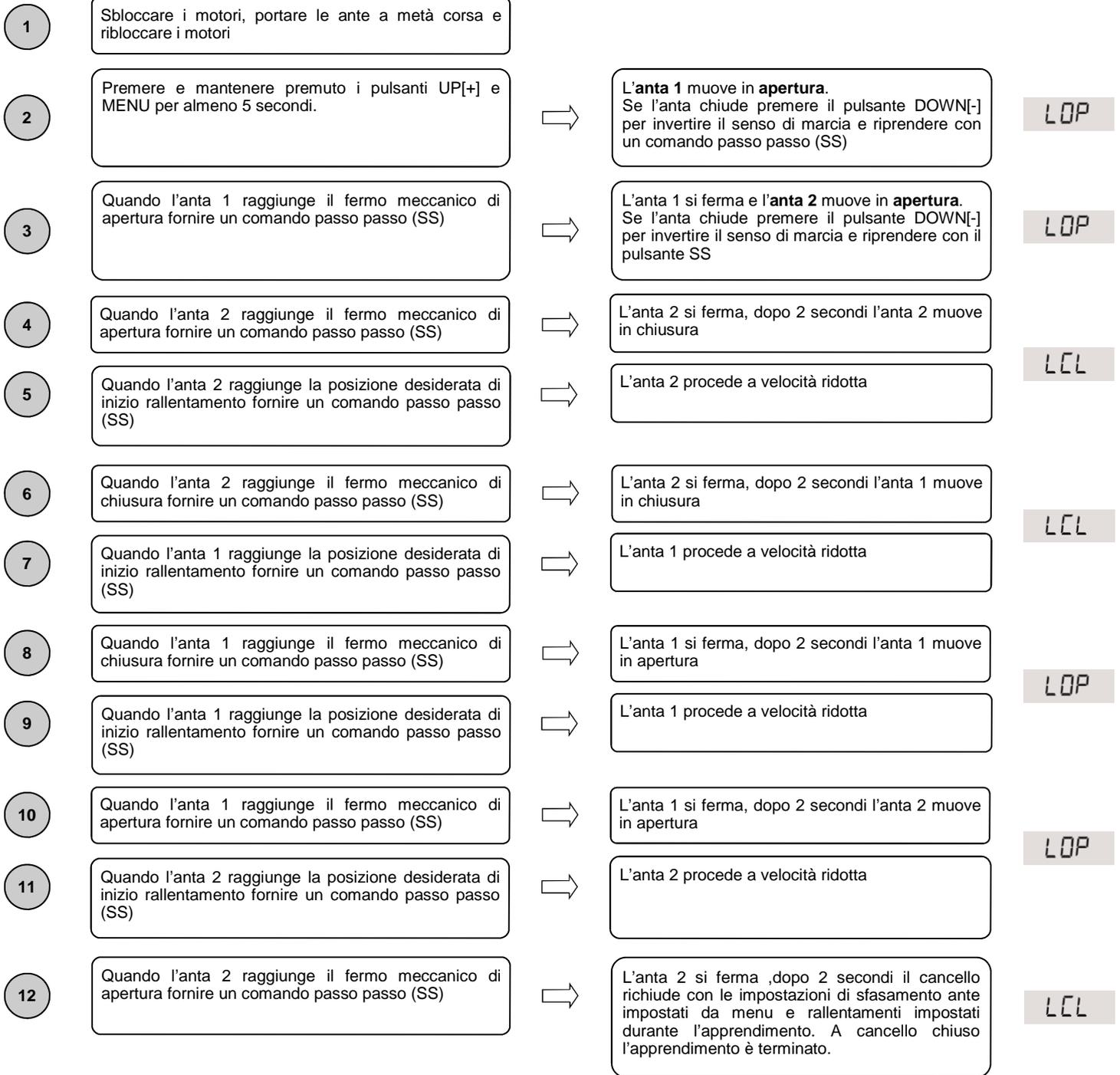
**Attenzione:** in caso di intervento di un dispositivo di sicurezza, la procedura viene arrestata e appare a display la scritta **L--**
