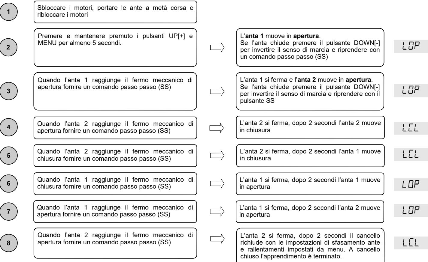
**Attenzione:** in caso di intervento di un dispositivo di sicurezza, la procedura viene arrestata e appare a display la scritta **L--**. Premere il tasto Passo Passo per ricominciare l'apprendimento dal punto 2.
