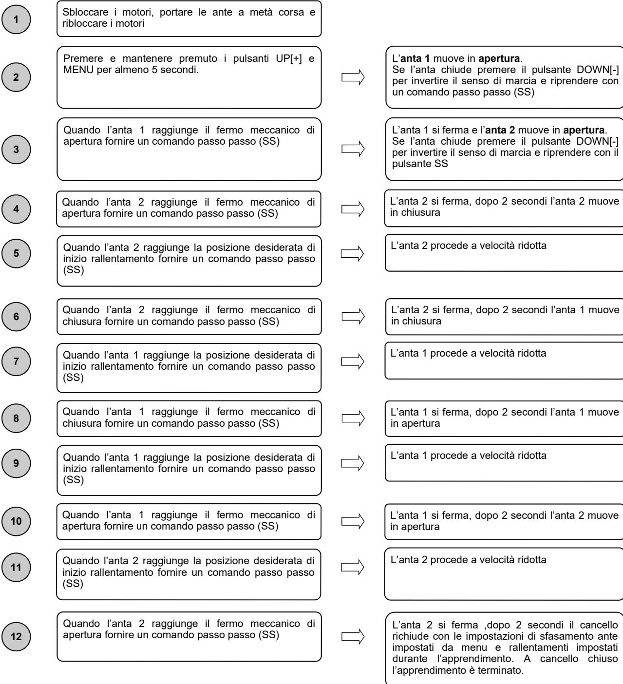
**Attenzione:** in caso di intervento di un dispositivo di sicurezza, la procedura viene arrestata e appare a display la scritta **L --**
