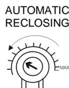
**ACHTUNG: die automatische Wiederverschließung wird deaktiviert falls während der Schließung einen Einsatz der Sensoren gegen Quetschung und die daraus resultierende Wiederöffnung stattfindet**
