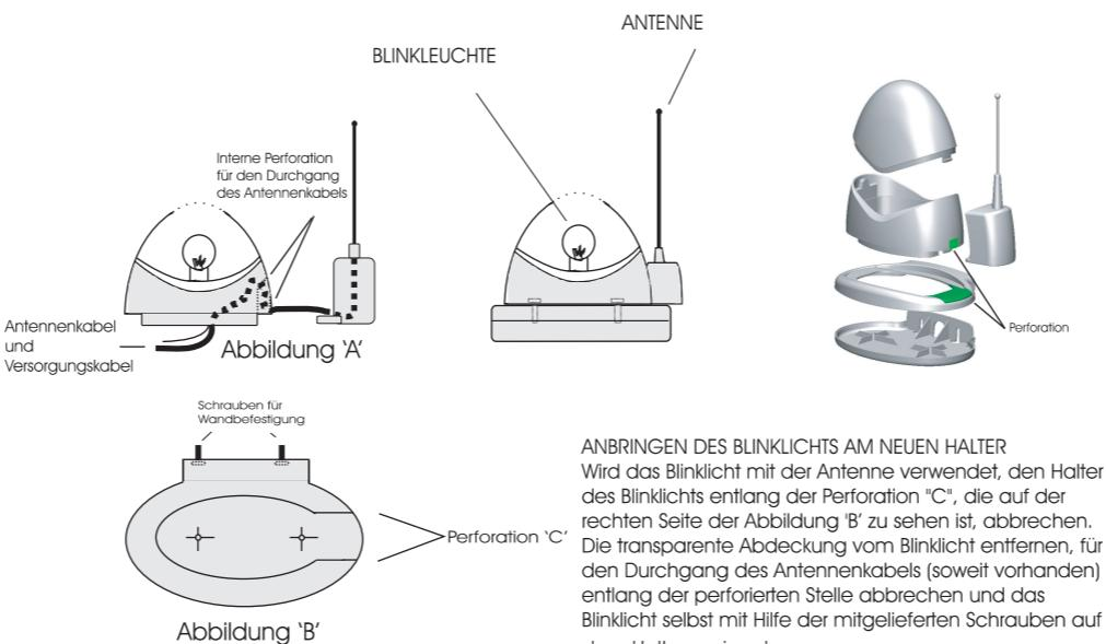
Mit beiden Versionen kann die Antenne, verfügbar für 30.875 - 40.665 - 300 - oder 433.92 Mhz., verwendet werden. Die Siegel sind: AL 30, AL 40, AL 300, AL 433. Für den Durchgang des Antennenkabels (soweit vorhanden) sehen sie Abbildung "A".
