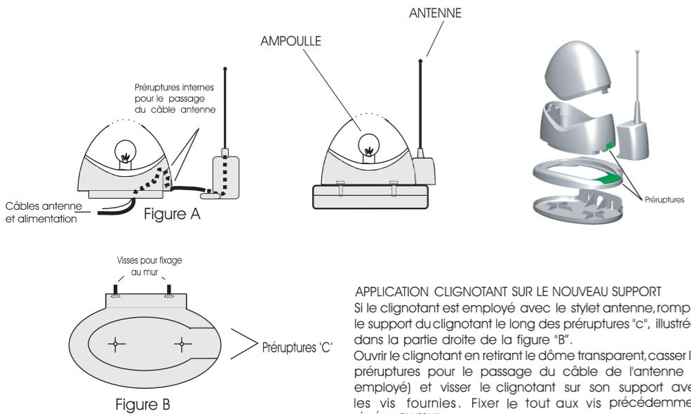
Sur les deux modèles, il est possible d'appliquer le spécial stylet antenne disponible pour fréquences 30,875 - 40,665 - 300 - ou 433,92 Mhz; les codes sont: AL 30, AL 40, AL 300, AL 433. Le passage du câble antenne, si employé, est illustré dans la figure A.
