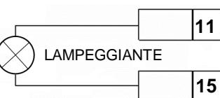
Collegare un eventuale lampeggiante con circuito di autolampeggio tra i morsetti L 11 (fase di ingresso) e N 15 (neutro motore).
