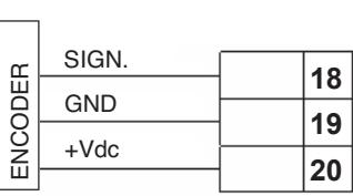
Conectar el cable de SIGNAL del encoder al borne 18 de la regleta de bornes.
