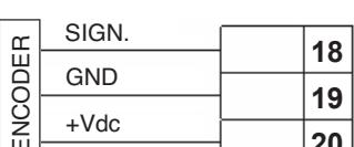
Brancher le cable de SIGNAL de l'encoder au borne 18 du tableau de commande
