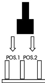
**POS.1:** El transmisor funciona en **MODALIDAD PASO PASO**. La tecla memorizado ejecuta la función **ABRE, STOP, CIERRA y STOP**.
