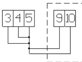
Los contactos 9 y 10 van puenteados al común como ilustrado solo si el puente J5 está cerrado y si no se conectan a los finales de carrera
