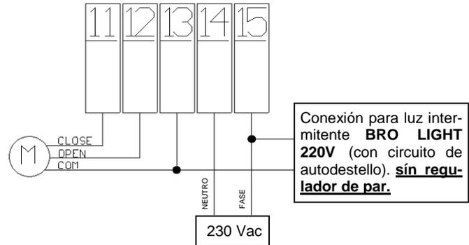
**IMPORTANTE!!!** TODOS LOS CONTACTOS N.C. NO UTILIZADOS DEBEN SER PUENTEADOS A LOS COMUNES COMO ILUSTRADO EN EL ESQUEMA INFERIOR.
