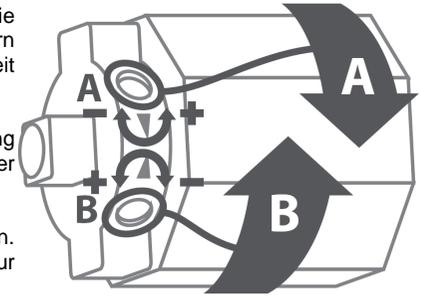
Der Pfeil auf dem Motorkopf zeigt NICHT unbedingt die Richtung der Automation an, sondern die Motordrehrichtung (wie auf der Figur dargestellt).
