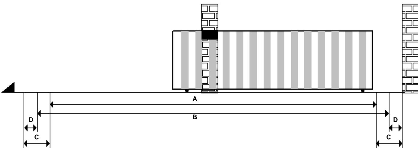
A = Zona di intervento del sensore amperometrico con inversione del movimento
