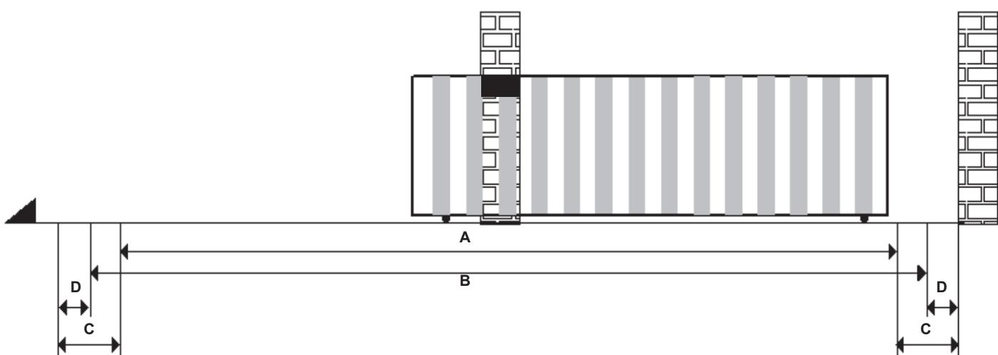
A = Eingriffszone des Strommesssensors mit Umkehrung der Bewegung
