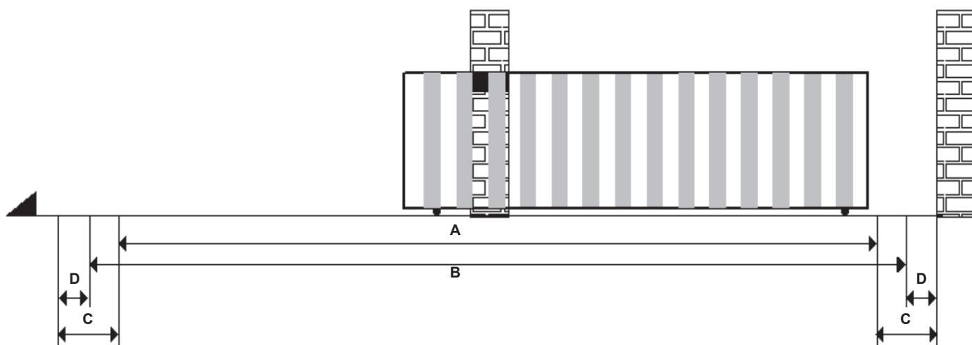
A = Zone d'intervention du capteur ampérométrique avec inversion du mouvement.
