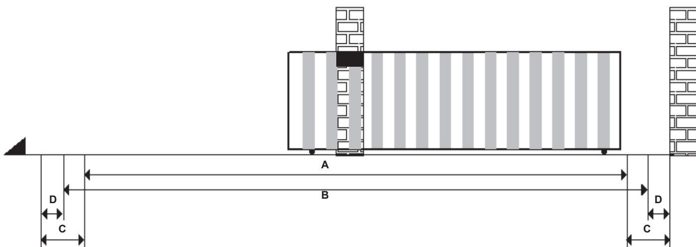
A = Zona de intervención del sensor amperométrico con inversión del movimiento
