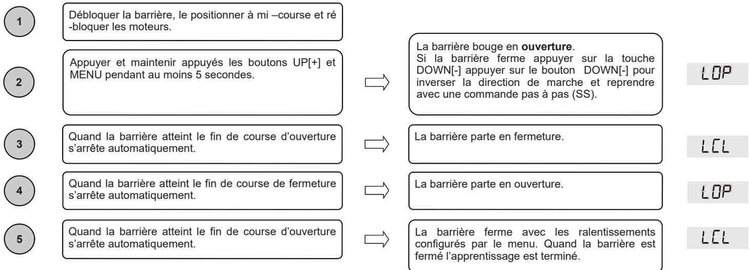
**Attention:** en cas d'intervention d'un dispositif de sécurité, la procédure sera arrêtée et l'écran affichera le message L--
