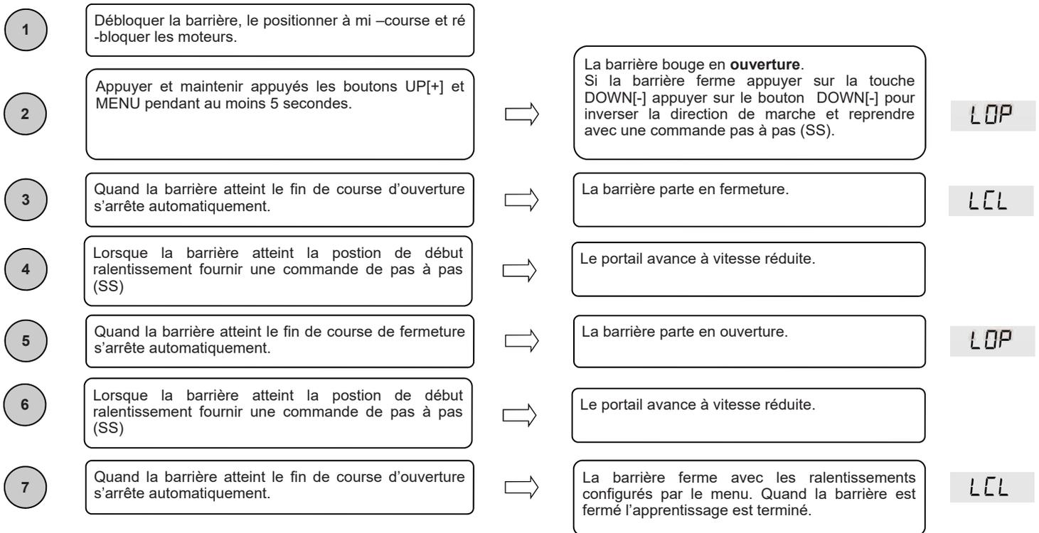
**Attention:** en cas d'intervention d'un dispositif de sécurité, la procédure sera arrêtée et l'écran affichera le message L--
