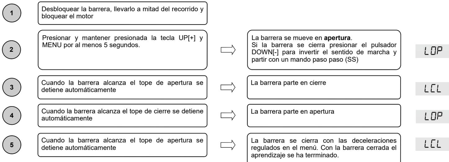
**Cuidado:** en el caso de intervención de un dispositivo de seguridad, el procedimiento se detiene y aparece en el display la palabra **L--**
