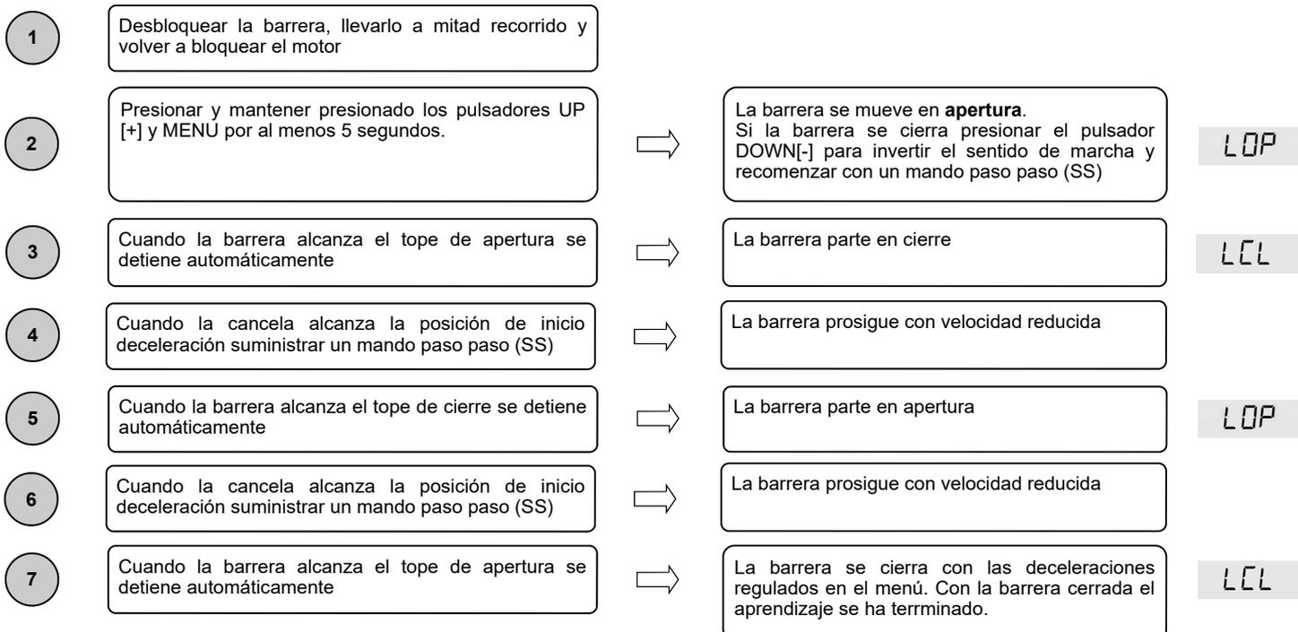
**Cuidado:** en el caso de intervención de un dispositivo de seguridad, el procedimiento se detiene y aparece en el display la palabra **L--**
