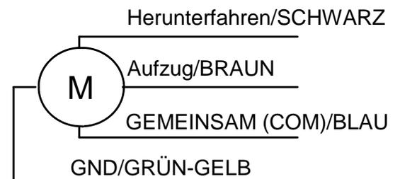
Achtung: Die Funktionen An- und Abstieg hängen von der Motororientierung ab. Falls auf ein Kommando Aufzug (up) das Kommando Herunterfahren (down) ausgeführt wird, so müssen die Kabel umgekehrt werden (braun = Aufzug und schwarz = Herunterfahren).
